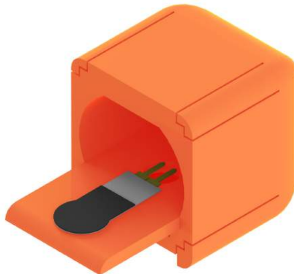
Abbildung VI.19: Montage des Drucksensors
