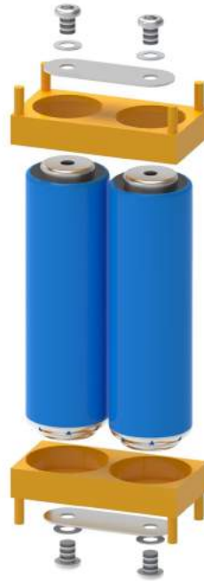
Abbildung V.2: Explosionsdarstellung einer Doppelzelle
