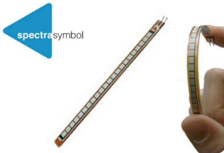
Abbildung III.15: Flex-Sensor von SpectraSymbol[58]
