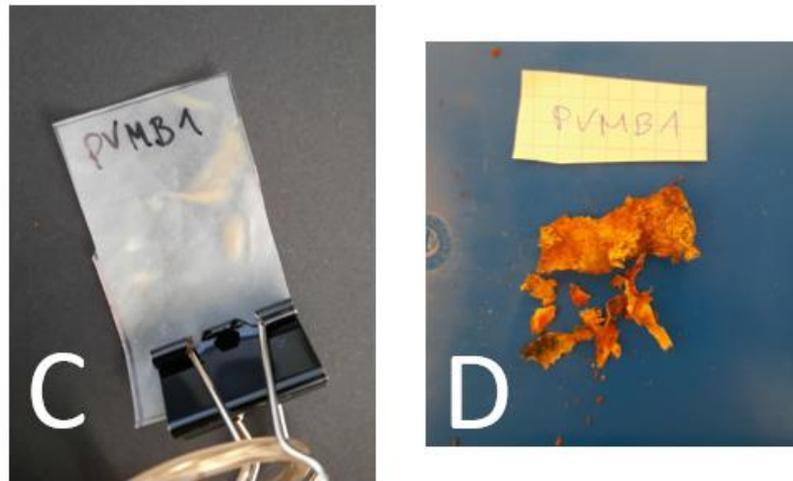
**Abbildung 29: Vergleich der Folien vor und nach der Kompostierung**
