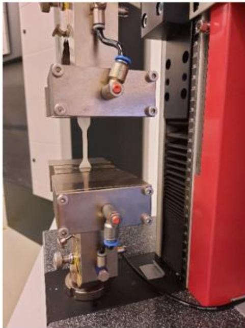
**Abbildung 36: Zugprüfmaschine und Prüfkörper**
