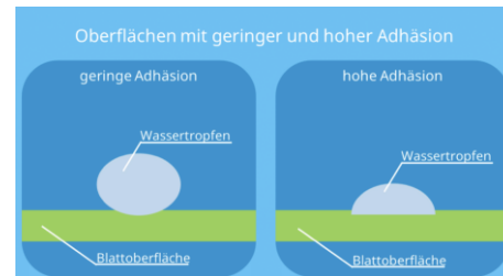
Abb. 2: geringe Kontaktfläche am Blatt bei geringer Adhäsion, hohe Kontaktfläche bei hoher Adhäsion
