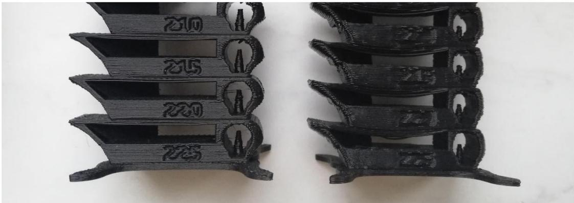
**Abbildung 37: Düsendurchmesser von 0,4 mm (links) und 0,6 mm (rechts)**
