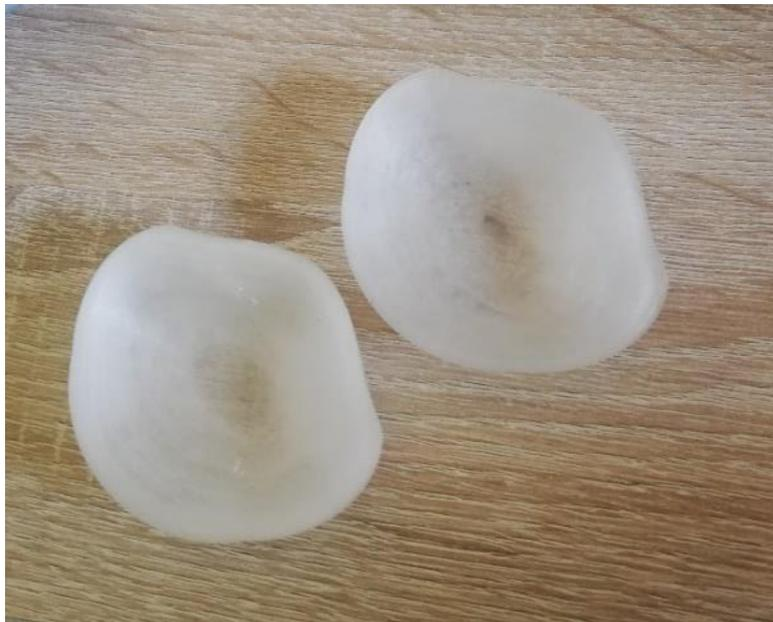
**Abbildung 39: Kinnkappen aus PMMA (links) und PP-Cop-1 (rechts)**
