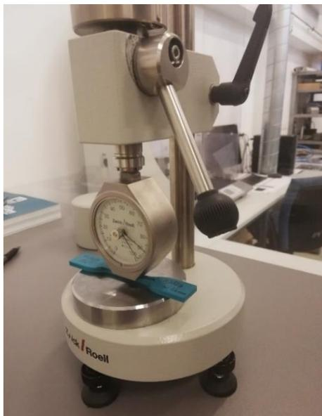
**Abbildung 41: Härtemessung einer PLA-Probe**
