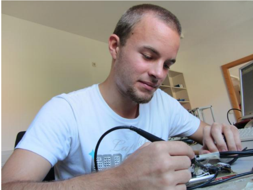
Abbildung 27 - Auflöten der einzelnen Komponenten auf die Leiterplatte
