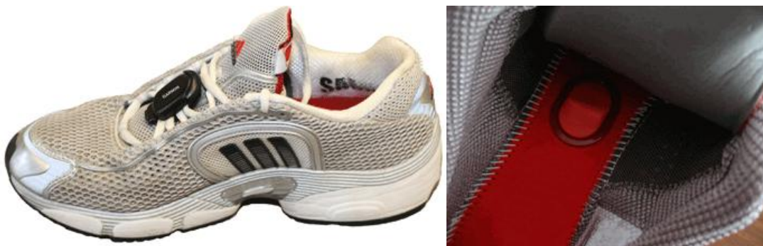
Abbildung 30 - Befestigung des Laufsensors (Foot Pod) am bzw. im Schuh
