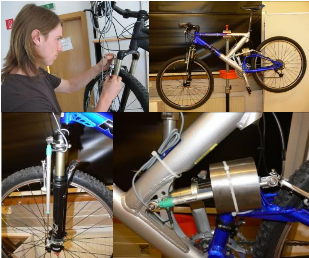
Abbildung 35 - Anbringung von Wegaufnehmern an Federgabel und Dämpfer
