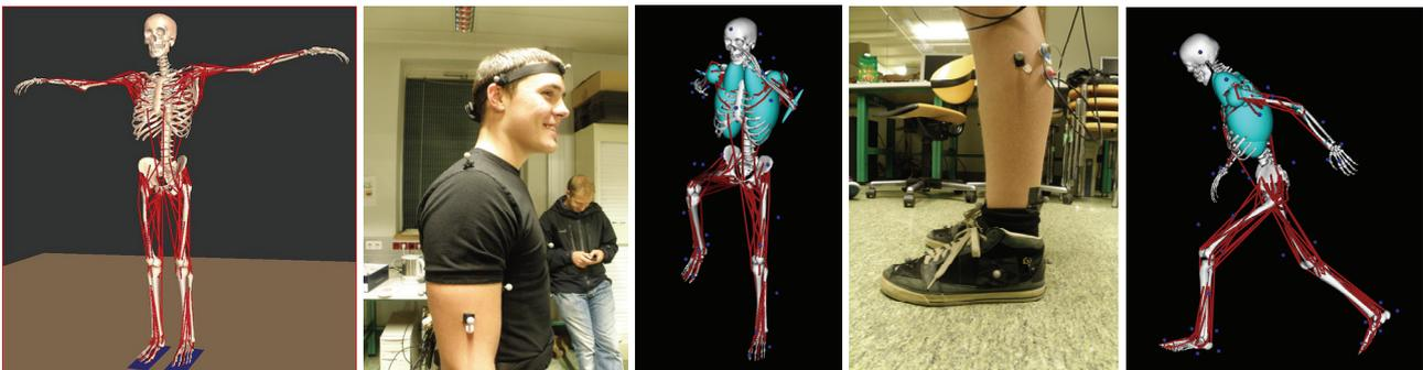
Beide Messsysteme werden elektronisch gleichzeitig gestartet. Die erhaltenen Daten werden einerseits in ein Ganzkörper-Modell in eine Software (SIMM, MusculoGraphics Inc.) einfließen, die es erlaubt, grafikbasiert mit muskuloskeletalen Modellen zu arbeiten und andererseits mittels Matlab und Excel weiter analysiert.
